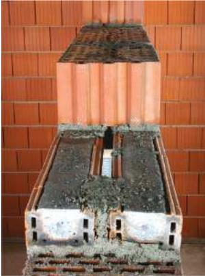
Керамобетонные перемычки Porotherm 120/65, состоящие из железобетонной сердцевины, применяются в оконных и дверных проёмах.
