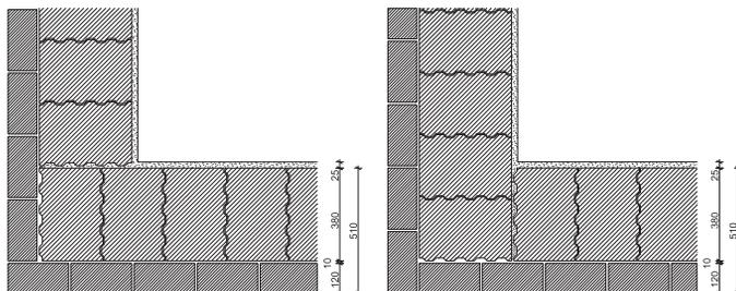
При кладке угла из блоков Porotherm 38 GL доборные элементы не требуются. Обращаем внимание, что вертикальный шов, образующийся в месте соединения гладкой поверхности блока с пазогребневой стороной другого блока, нужно заполнить тёплым раствором во избежание образования щели или мостика холода. Доборные блоки Porotherm 38 ½ используются также при кладке оконных и дверных проёмов.
