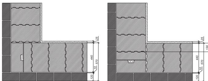
Для правильной перевязки вертикальных швов в наружных и внутренних углах рекомендуется использовать доборные блоки Porotherm 44 R и Porotherm 44 1/2.
