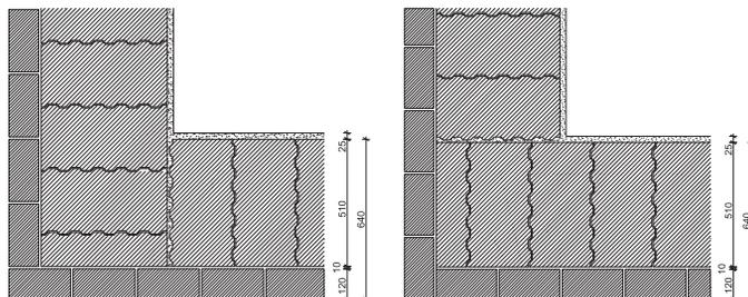
При кладке угла из блоков Porotherm 51 GL рекомендуем использовать доборные блоки Porotherm 51½, которые позволяют избежать распилки блоков и возникающих в связи с этим неудобств. Обращаем внимание, что вертикальный шов, образующийся в месте соединения ладкой поверхности блока с пазогребневой стороной другого блока, нужно заполнить тёплым раствором во избежание образования щели или мостика холода.
